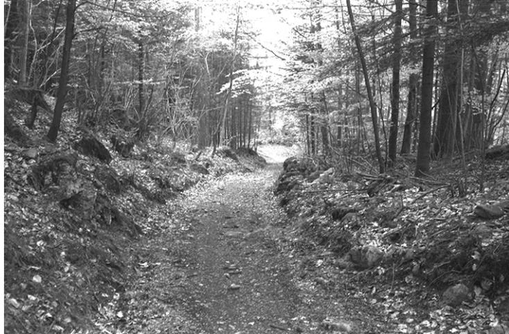
Im anschliessenden offenen Gelände der Summerweid verschmälert sich der Weg auf 1 bis 1.5 m Breite. Er wird stellenweise von heckenbestandenen Böschungen sowie von Lesestein- oder Trockenmauern gesäumt. Die Oberfläche ist eine Mischung aus Steinbett und erdig-steinigem Lockermaterial, das zunehmend mit Gras überwachsen wird.
