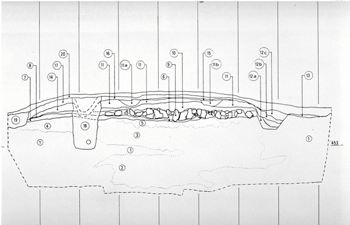
*Die Detailaufnahme des Strassenprofils zeigt die Abfolge der Schichten und den Aufbau der Strassenkonstruktion mit der gesetzten Kofferung und den aufliegenden Kiesschichten.*
